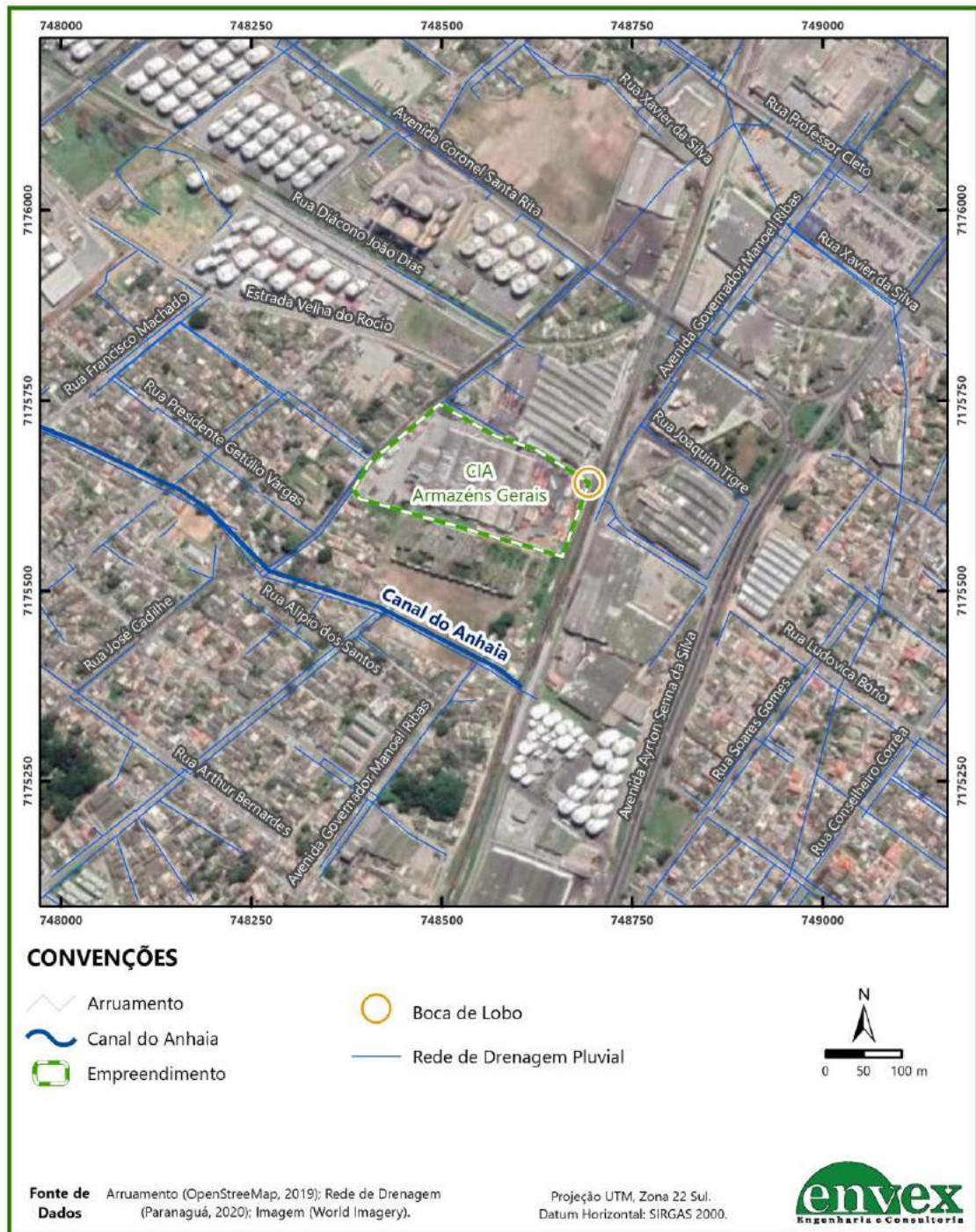
Figura 50: Localização da boca de lobo da Cia de Produtores, em relação a rede pluvial municipal.
